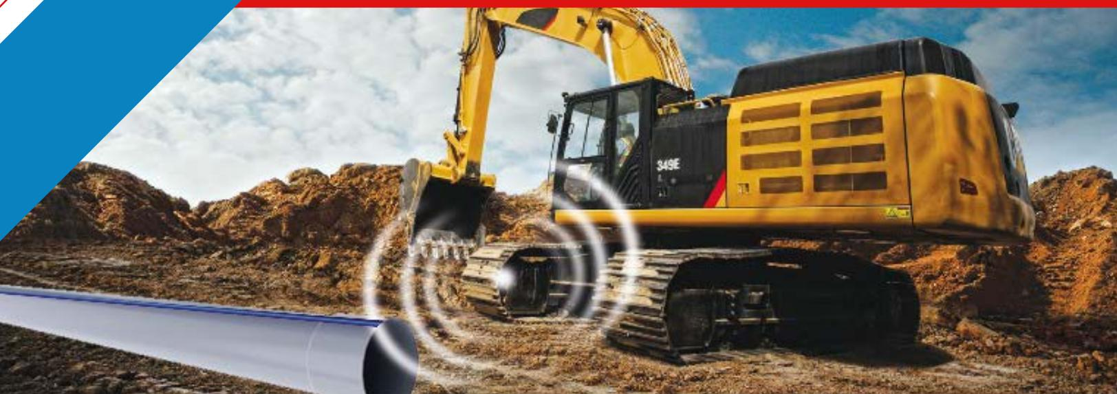
El sistema de monitoreo con fibra óptica de sensibilidad acústica, proporciona en tiempo real una evaluación por medio de la acústica de la tubería o el terreno circundante, envía una señal por medio de pulsos luminosos que un software de análisis decodifica, con el propósito de detectar cualquier cambio significativo en el entorno de la tubería.
