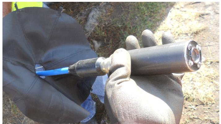
Instalación del sensor acústico
