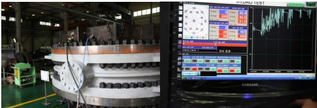
Prueba de hermeticidad Cuerpo en 12266 1.5 X PN= 60 bares 10 Minutos
